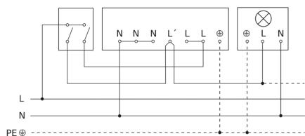
**Schema elettrico Collegamento tramite un commutatore per il funzionamento continuo e automatico**
