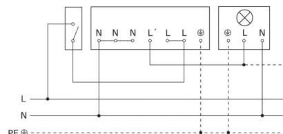
**Allacciamento tramite un interruttore in serie per uso manuale e automatico**
